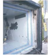
Abb. 5 nach Feuer- u. Sturzttest aus 9,15 m Höhe (Innenraum ist unversehrt)
