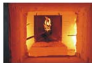
Abb. 2 Schrank wird beflammt 1 Stunde bis 1090° Hitze bringt Schrank zum Glühen
